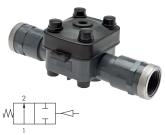
Selbstentleerung: 3° - 6° zur Durchflussrichtung geneigt und 25° - 33° zur Waagerechten gekippt
