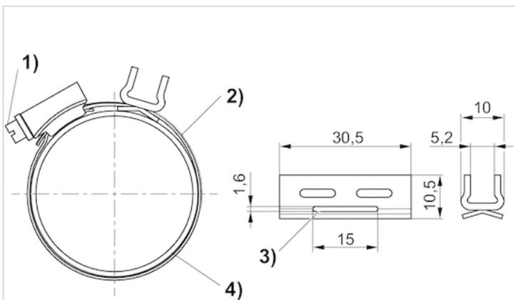
1) Befestigungsschraube 2) Spannband 3) Durchlass für Spannband 4) Zylinderrohr
