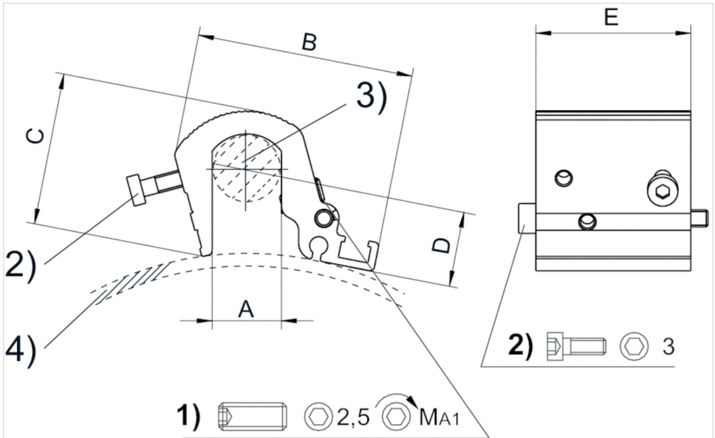
1) Klemmgewindesttift 2) Befestigungsschrauben für Sensor 3) Zuganker 4) Zylinderprofil
