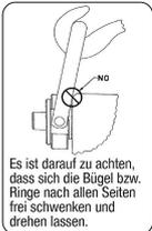
Es ist darauf zu achten, dass sich die Bügel bzw. Ringe nach allen Seiten frei schwenken und drehen lassen.
