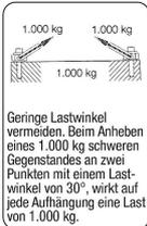
Geringe Lastwinkel vermeiden. Beim Anheben eines 1.000 kg schweren Gegenstandes an zwei Punkten mit einem Lastwinkel von 30°, wirkt auf jede Aufhängung eine Last von 1.000 kg.
