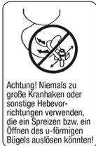
Achtung! Niemals zu große Kranhaken oder sonstige Hebevorrichtungen verwenden, die ein Spreizen bzw. ein Öffnen des u-förmigen Bügels auslösen könnten!
